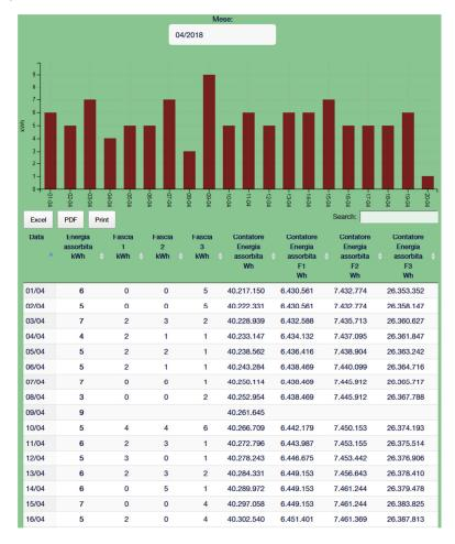
In impianti dotati di produzione elettrica da energie rinnovabili, se sono presenti due contatori (scambio e produzione) i dati di entrambi sono acquisiti.
